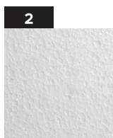
2 Wypełnienie sponionym polistyrenem EPS
